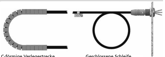
C-förmige Verlegestrecke (Schleppkette) C-Track
