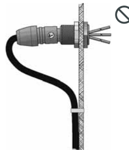
Entlastungsschleife – falsch Incorrect stress loop
